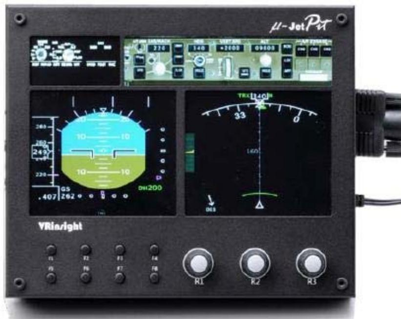
Le **μJetPit** de VRinsight est un panel portatif pour tous les appareils de type Jet. Il dispose d'un ND, PFD, EFIS et MCP ainsi que tous les boutons réels. Tous les instruments, boutons et boutons rotatifs sont synchronisés avec les avions par défaut de type Jet de Microsoft Flight Simulator et les avions additionnels du même type. Le **μJetPit** est complètement interfacé avec MSFS 9 et MSFS X grâce au port USB et le logiciel "Serial FP2" (inclus).
