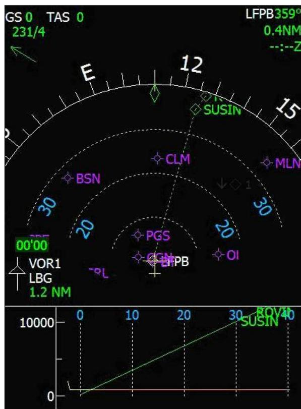
La pantalla de navegación recoge todos los datos relativos a la navegación vertical y lateral. Ésta dispone de 5 modos de presentación y de mostrarse y de varios parámetros de alcance que pueden ser seleccionados en el panel de control EFIS.
