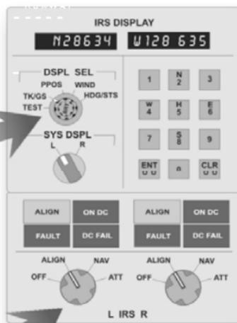
Los pilotos deben activar las unidades 10 minutos antes de mover el avión y decir al IRS donde se encuentra durante la configuración del cockpit. Para activar y alinear las unidades, los pilotos giran **AMBOS** mandos de la posición **NAV** a la **ALIGN**. Si **HDG/STS** está seleccionado, los datos de la ventana derecha indicaran los minutos restantes hasta que la alineación se complete.
